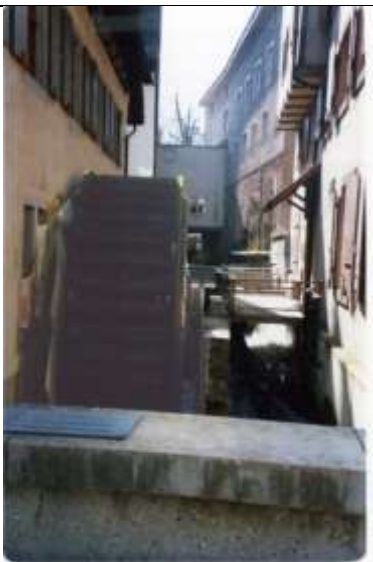
La ruota a pale sul canale che muove il maglio per macerare la carta nel Museo della carta adiacente
